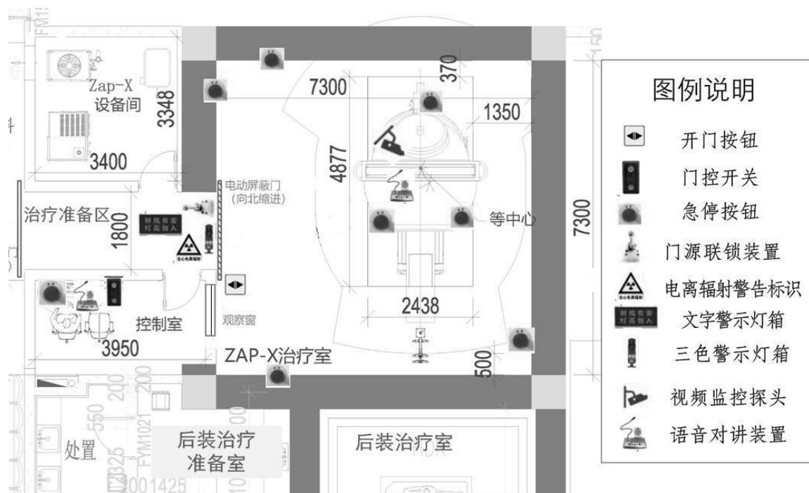
图 10.2-5 ZAP-X 治疗室安全设施布置示意图
